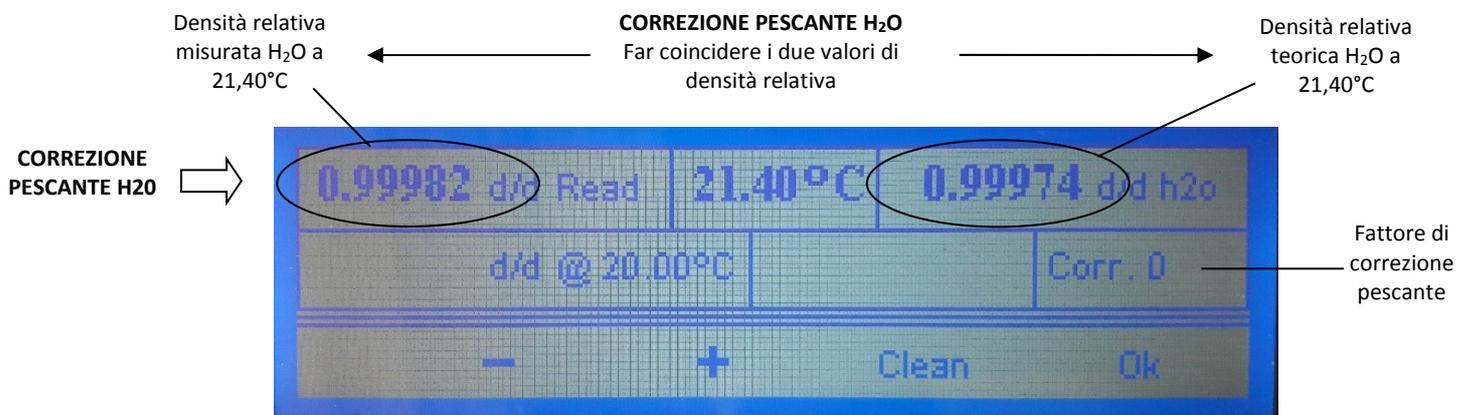
Fig. 7b: Correzione del pescante
