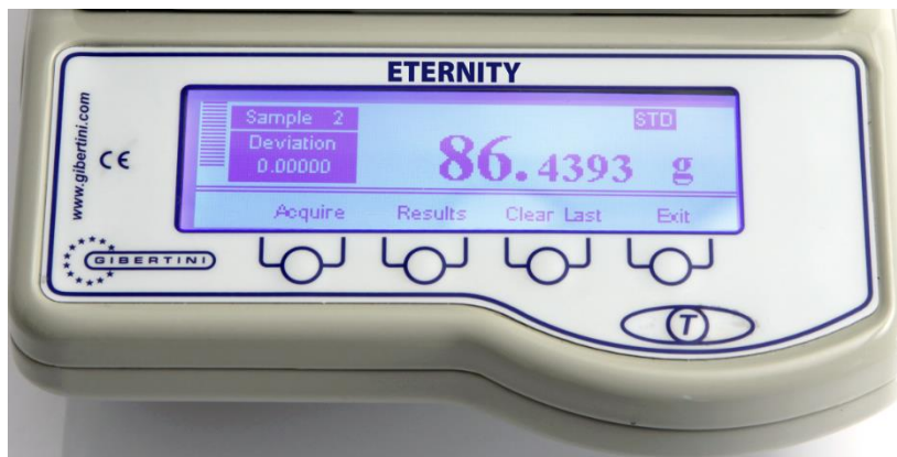
Particolare tastiera Eternity 200 in modalità Deviazione Standard - FIG. 4
