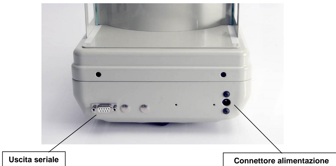
FIG. 2 - Particolare retro bilancia
